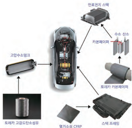
그림 5. Toyota MIRAI의 탄소소재 부품 (출처 : Toray)
