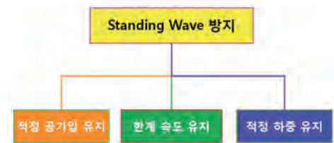
그림 15. 타이어 Standing Wave 방지
