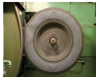
그림 14. 타이어 Standing Wave 현상
